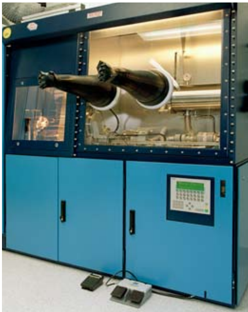
Epitaxieanlage im FIRST, bei denen unterschiedliche chemische Verbindungen, aufgebracht auf ein Substrat, einkristalline Schichtstapel wachsen lassen.
